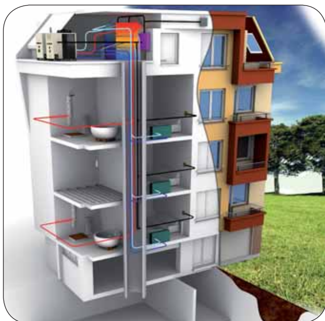
Przykład zastosowania GA-HR z rewersyjną pompą ciepła GAHP-AR w lecie do współpracy z klimakonwektorami i produkcji C.W.U.
